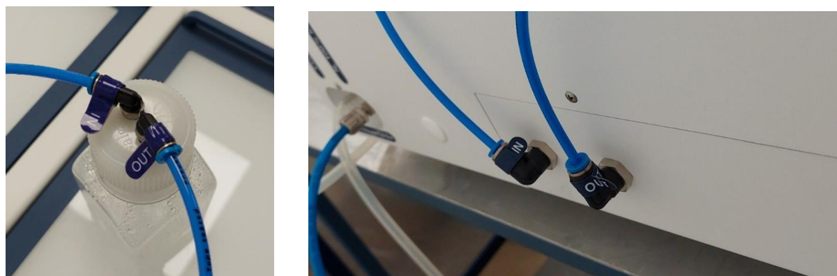
Figura 23.1 Raccordo del tubo sul flacone umidificatore e sull'incubatore multicamera IVF MIRI® Humidity
